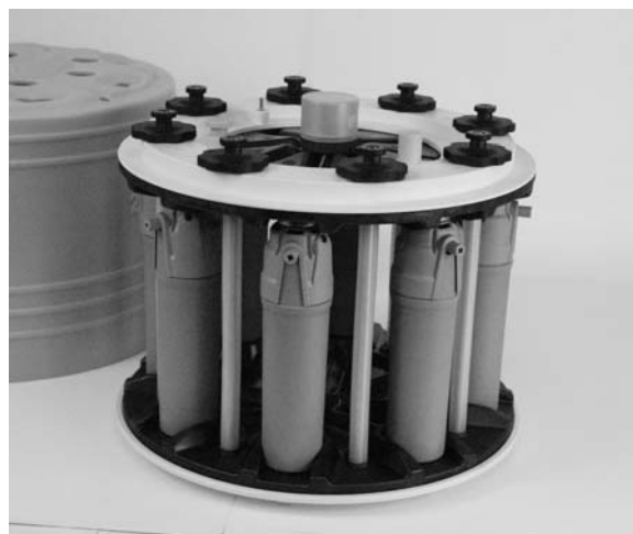
1. ábra. Zárt edényű savas feltáráshoz tervezett nyolcpozíciós mikrohullámú rotor és egy mintaedény
