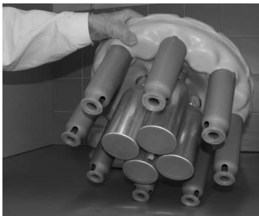
3. ábra. Az extrakciós rotor alulnézeti képe a mintaedényekkel és a kondenzációs tartályokkal
