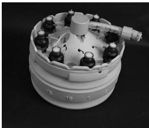
2. ábra. Zárt rendszerű bepárláshoz tervezett nyolcpozíciós korszerű mikrohullámú rotor
