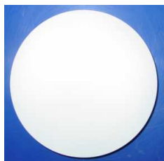
7. ábra A cink-peroxiddal borított kvarc korong
