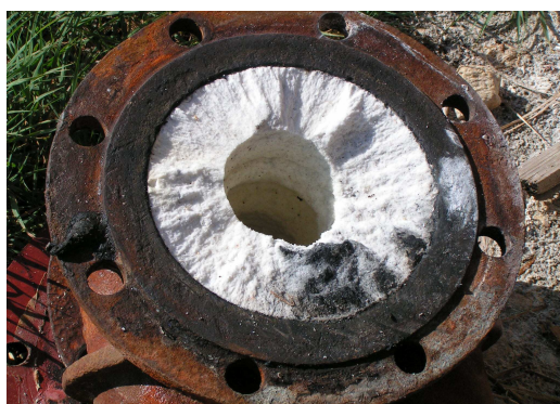
2.1. kép: Vízkőkiválás egy termálkút csövének belső falán (Szentés, 2006)
